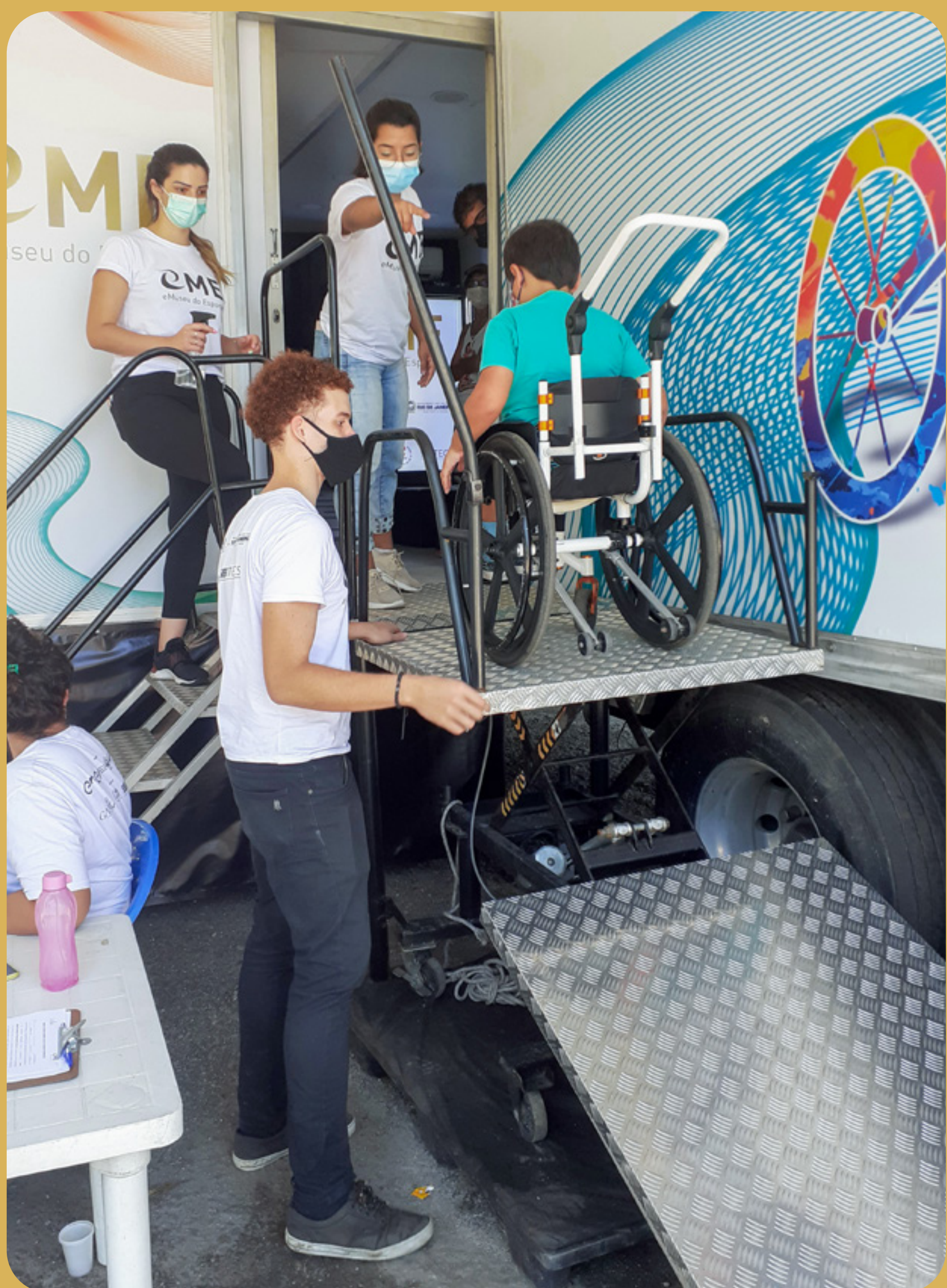
Inclusão e acessibilidade na carreta: rampa acessível para usuários de cadeira de rodas.
